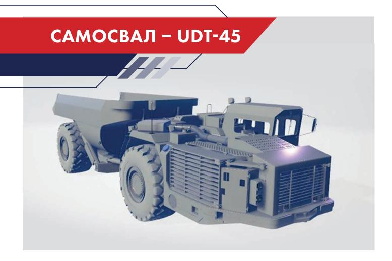
UDT-45 — это высокопроизводительный 45-тонный шахтный самосвал, предназначенный для использования на перегонах 4,5 x 4,5 м. В основе производительности самосвала
