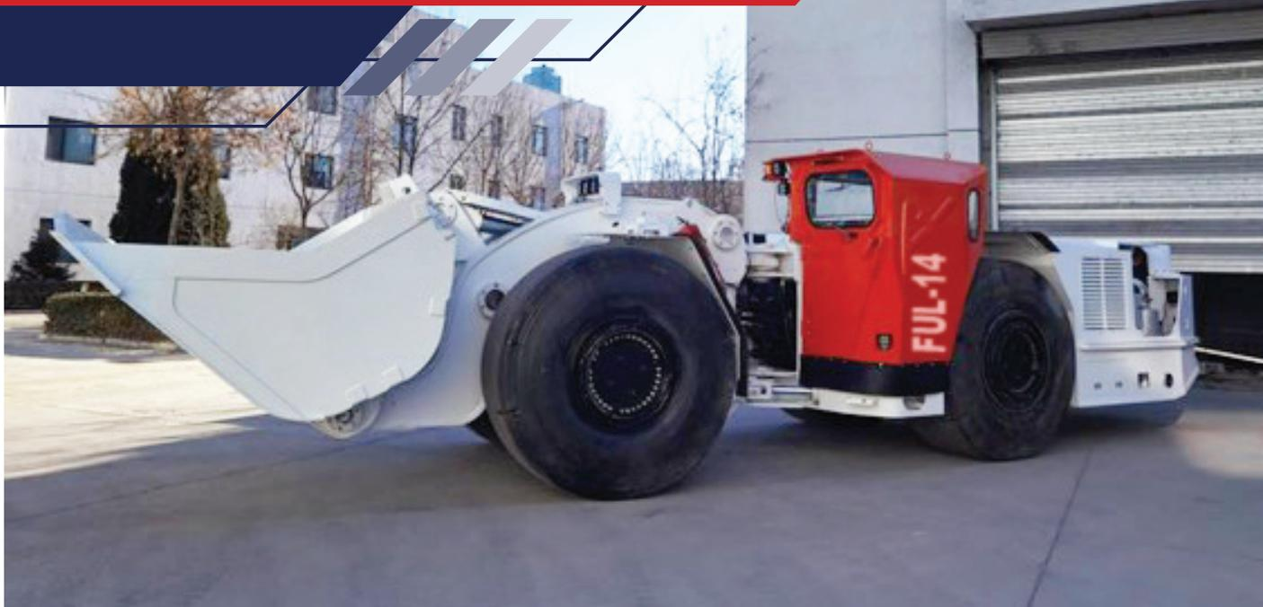
ПДМ – FUL-14 4 — это 14-тонная погрузочно-доставочная машина (LHD), разработанная специально для подземных работ самого разного назначения, включая разработку месторождений, горные работы и строительство тоннелей. Она
